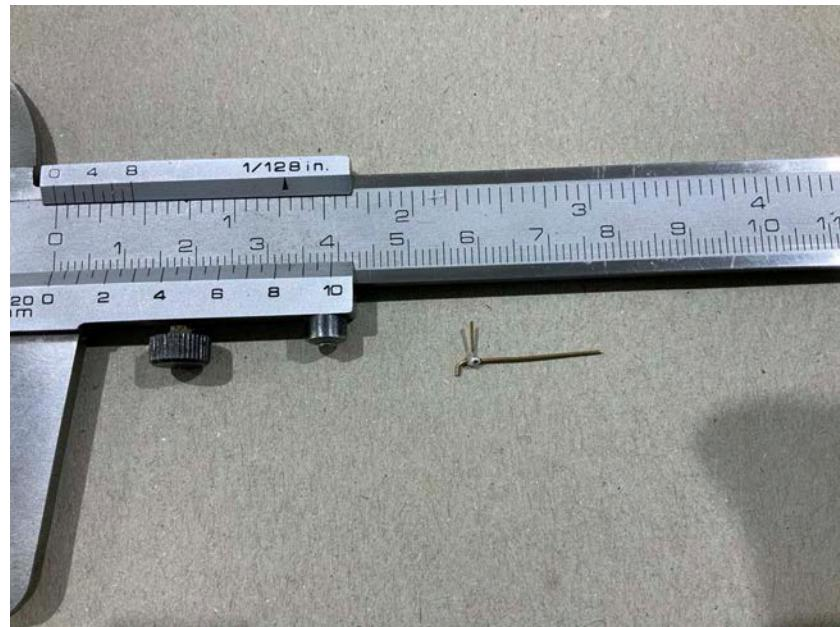
Im nächsten Schritt kürzen wir den „Ventilschaft“ etwas ein und löten auf diesen ein weiteres Stück Messingdraht von ca. 1,5-2mm Länge rechtwinklig und mit wenig Lötzinn auf. Dieses stellt dann den Griff des Ventils dar. Vor dem anlöten feilen wir aber die Enden wieder Gerade!
