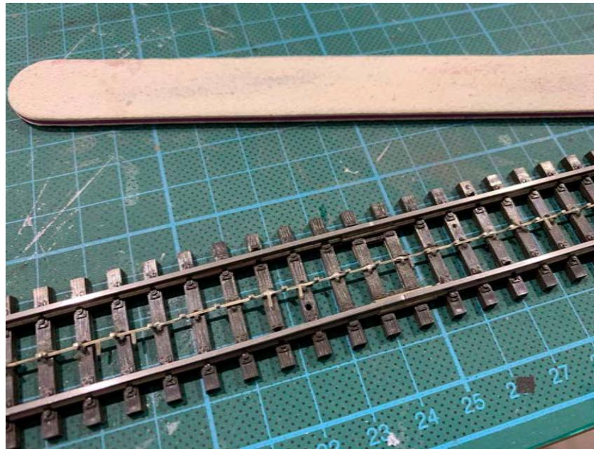
Was Übersteht wird mit einer Nagelfeile oder ähnlichem auf Maß geschliffen. Kommen wir nun zum „Beton“.
