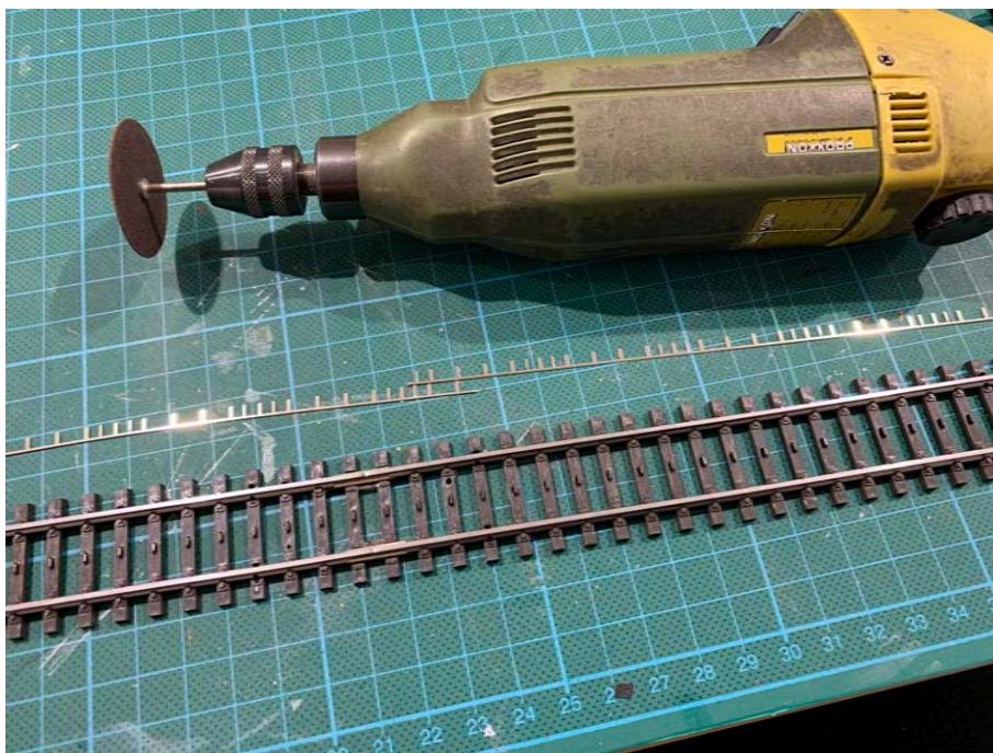
Mit der Trennscheibe schleifen wir mittig in die Punktkontakte eine Nut entsprechender Tiefe. Die Punktkontakte sollten beim
