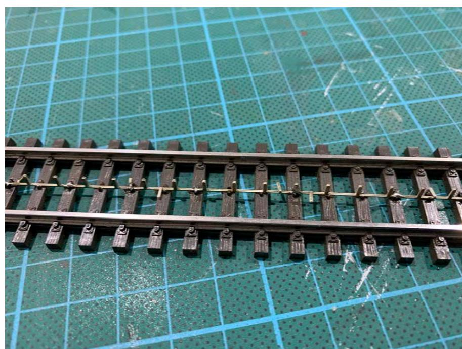
Es müssen dabei nicht alle Punktkontakte verlötet werden. Ich habe hier jeden 3. -4. Punktkontakte mit etwas Lötfett eingestrichen und verlötet. Ist dieser Arbeitsgang abgeschlossen werden die Punktkontakte darauf hin überprüft, ob sie nicht über das Schienenprofil hinausragen.
