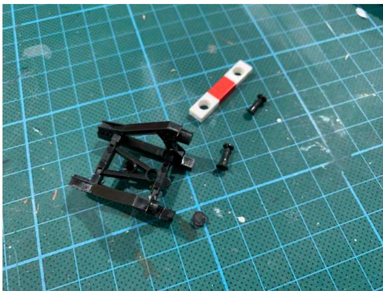
Die Pufferbohle wieder aufstecken und die entstandenen Löcher mit Kunststoffspachtel verschließen.
