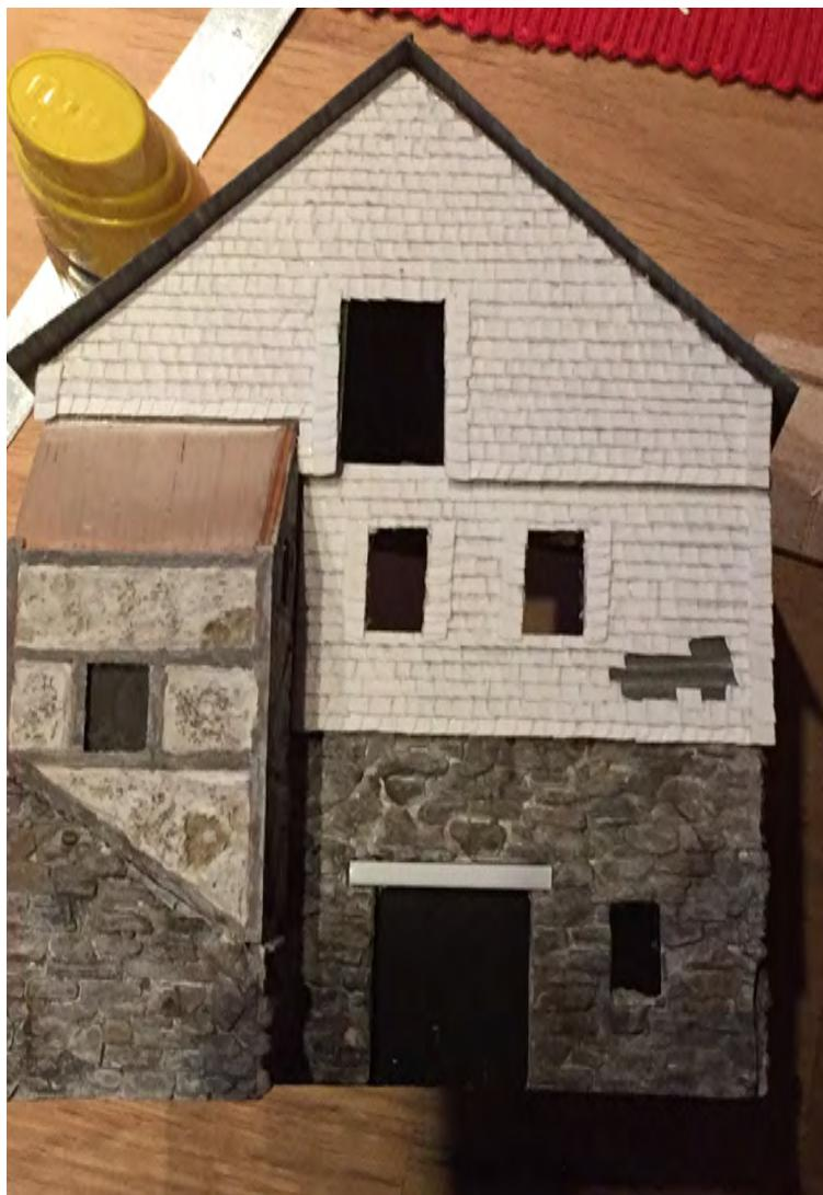
Und da wir jetzt so schön in Übung sind geht es gleich mit dem Dach weiter. Hier sind Bieberschwänze verlangt. Ausgangsmaterial sind wieder unsere 1,5mm breiten Zeichenkartonstreifen. Dieses mal schneiden wir sie aber nicht mit dem Eckenverrunder, sondern stechen sie mit einer Länge von ca. 2-2,5 mm mit einem kleinen Halbrunden Hobbystechbeitel (wie im Bild zu sehen ab).
